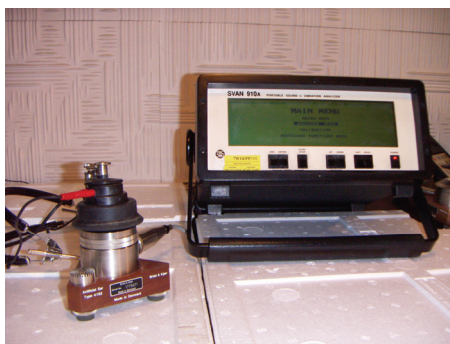
Rys.1. Sprzęgacz akustyczny typu 4152 oraz stanowisko pomiarowe Fig. 1. Acoustic coupler type 4152 and the measurement stand
