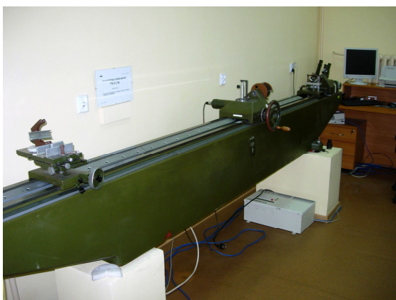
Rys. 1 Widok maszyny pomiarowej 1-D Carl Zeiss Jena; Rys. 2. Widok stanowiska pomiarowego własnej konstrukcji Fig. 1. View of the 1-D Carl Zeiss Jena measuring instrument; Fig. 2. View of the self-construction measuring setup
